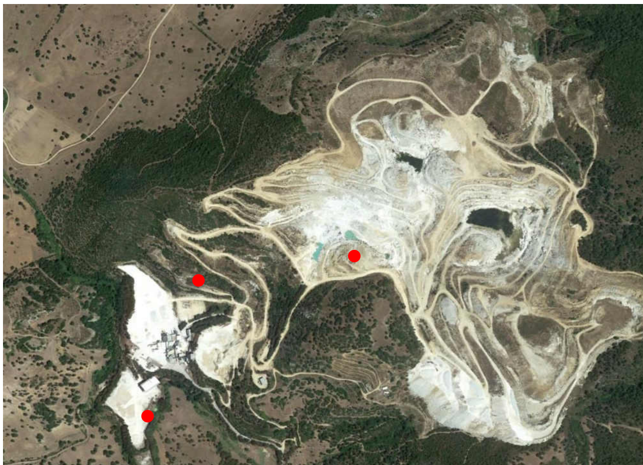
Figura 65: punto di campionamento dell'aria per la misura delle polveri
